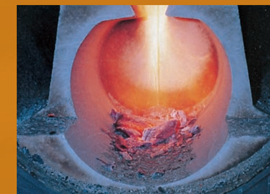
Hoření plamene v keramické spalovací tvarovce
