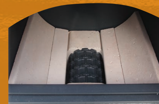
Pohled do horní spalovací komory
